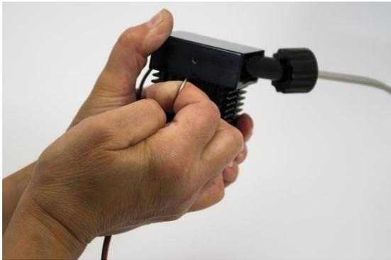
Introduire les 2 extrémités de l'agrafe dans les orifices correspondant du caloduc.
