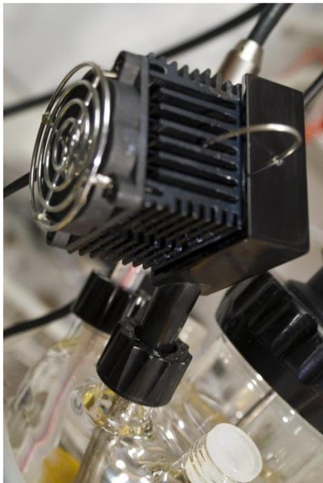
Insérer le module de refroidissement dans un col latéral de la cuve du fermenteur et le fixer par un bouchon à vis.
