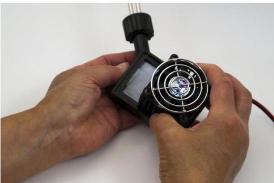
**Glisser le module Peltier horizontalement sur la plaque d'échange de chaleur du caloduc.**
